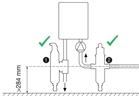
Einer schmutzigen, problematischen Anlage würde es zugutekommen, wenn die kombinierte Einheit in der Rücklaufleitung, so nahe am Kessel, wie praktisch möglich, installiert wird, oder hinter dem letzten T-Anschluss in der Rücklaufleitung. Die kleinen Durchflussöffnungen in Kesseln müssen, abhängig von den Umständen der Anlage, beachtet werden.
